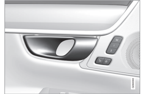
Openingsgreep voor alternatieve ontgrendeling op zijportier 10 .
